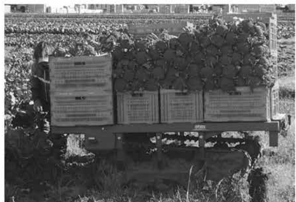
ブロッコリーをまたいで運搬する収穫運搬車
