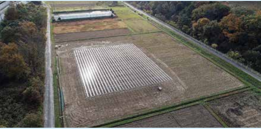
▲全体の水田圃場面積は約5反、内1.3反に発電パネルを試験的に設置。(写真提供 太啓建設)
