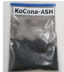
燃烧の際、灰は20%排出されるが、 土壌改良や消臭剤として利用可能
