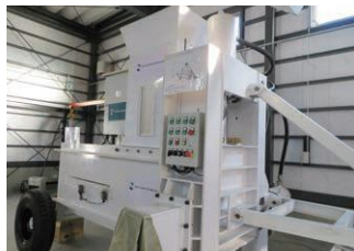
粉末状にしたもみ殻を保存用に 圧縮するための機械
