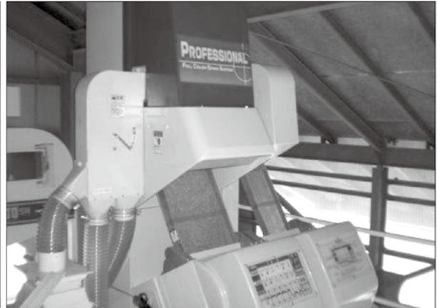
写真 15 色彩選別機によりカメムシ被害粒を除去
