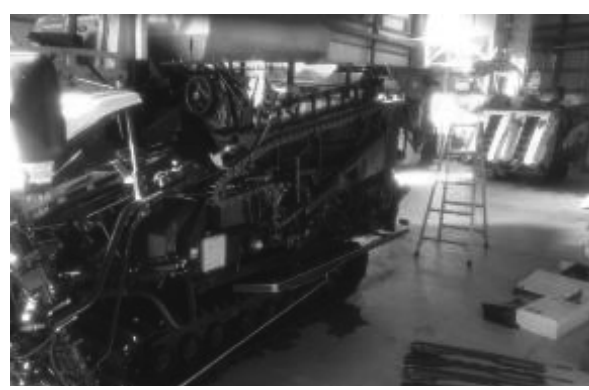
写真 29 コンバインの分解整備
