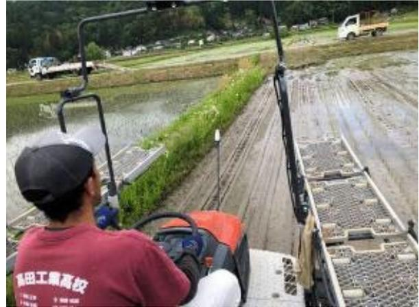
写真 19 GPS 付き田植え機を用いた田植え作業
