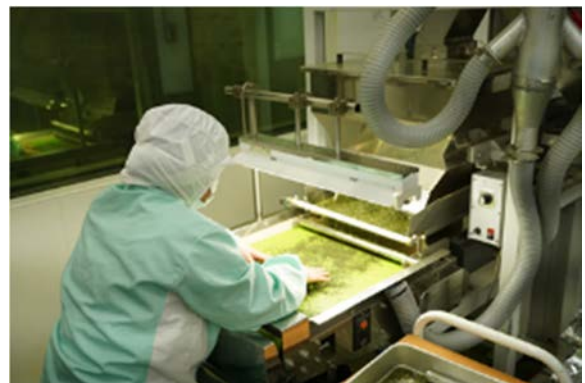
写真8 異物混入対策の取組（目視）
