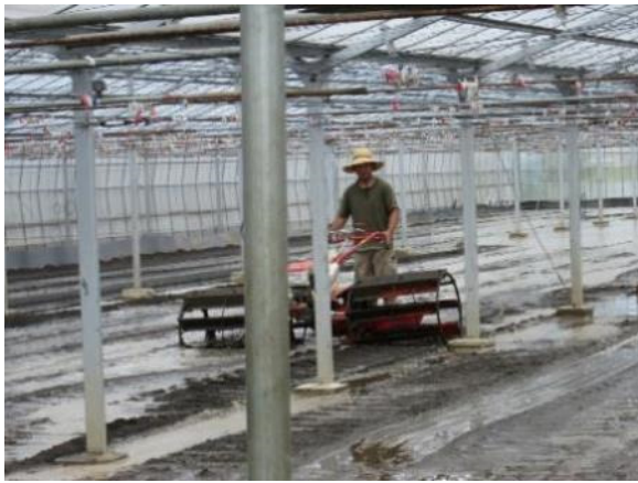
写真6 レンコン用代掻き機を利用した深層還元型太陽熱土壤消毒の様子
