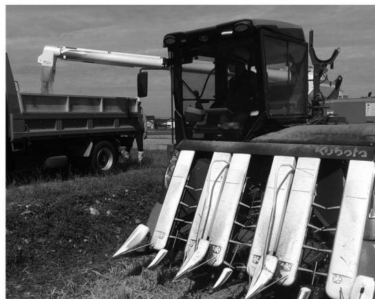
写真6 食味収量センサ付きコンバインでの収穫風景
