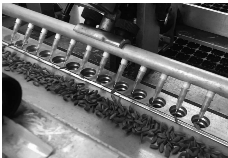
写真6 ニードル式の自動播種機によるセルトレイへの播種
