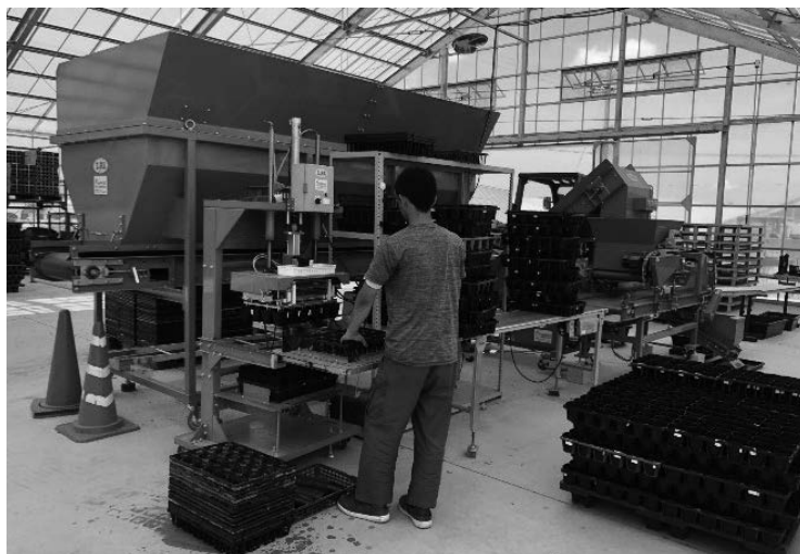
写真5 ポットティングマシンによるポリポットへの土詰め
