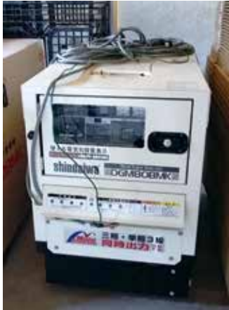
写真15 停電対策で大型自家発電機を活用
